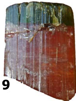
Figuur 8. Streping op de prismavlakken van toermalijn.
